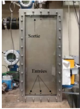
Figure 1 : Photographie du canal (face)
