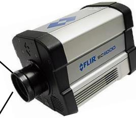
Caméra IR, 240 lig, 320 col, étalonnée en luminance dans la fine bande  $\Delta\lambda = 0.8\mu\text{m}$  autour de  $\lambda_0 = 4.1\mu\text{m}$
