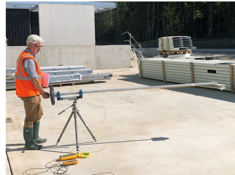
Mesure en large bande et 8-14 $\mu$ m, large surface de mesure adaptée aux matériaux de construction
