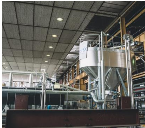
Démonstrateur sur réseau de chaleur de Berlin (SaltX) Chaux 350/80°C
