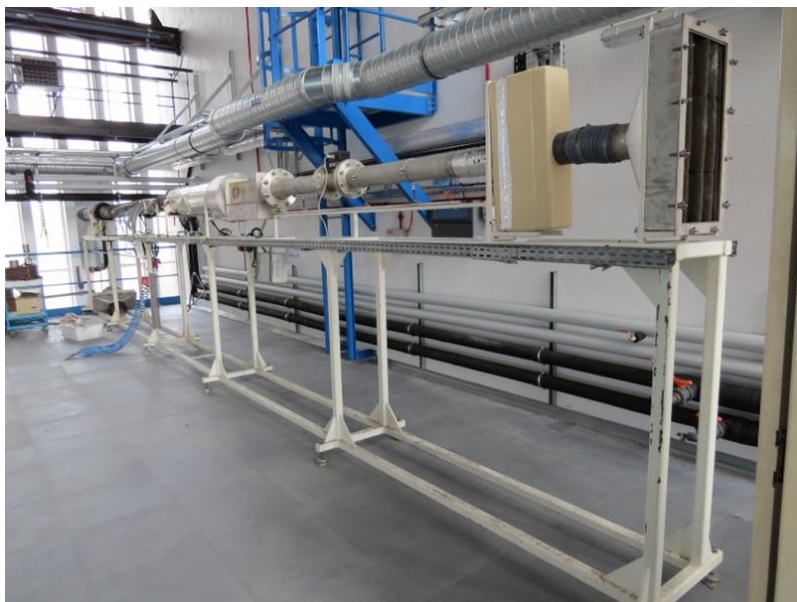
Boucle d'essai d'encrassement en phase air
