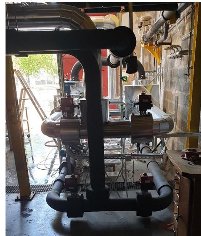
Boucle d'essai d'encrassement en phase liquide
