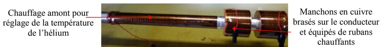
Figure 4 : Vue de la maquette #2 testée au CEA de Grenoble sur l'installation HELIOS
