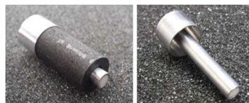
Figure 3 : Assemblages présents dans la tête de la cellule de mesure (à gauche) et de la cellule de référence (à droite)
