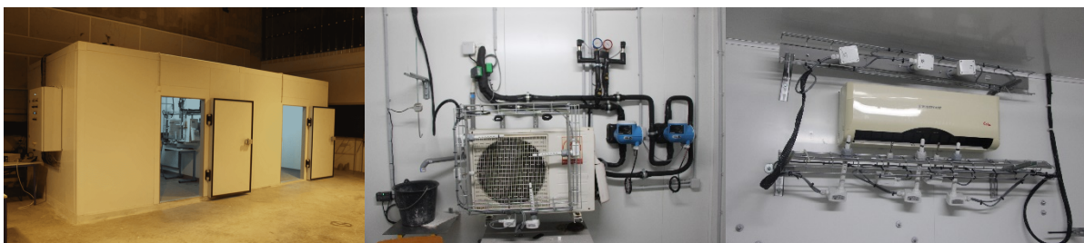
Figure 1 : Banc d'essai : (a) vue globale des deux chambres climatiques, (b) unité extérieure du split instrumenté, (c) unité intérieure du split instrumenté
