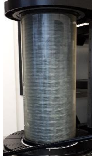
Figure 2 : Système de Taylor-Couette avec visualisation de l'écoulement turbulent pour Re = 2,5 \cdot 10^4 , Gr = 0
