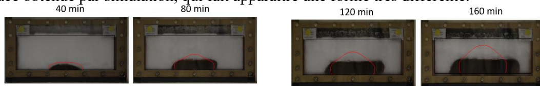
Figure 4 : Visualisations en cours de fusion à t=40 min, 80min, 120 min et 160 min- chauffage par la paroi horizontale – trait rouge : position du front liquide-solide obtenue par simulation
