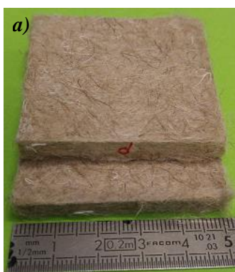
Figure 1 : Echantillon d'isolant thermique FFL ( 50 \times 50 \times 4,5 \text{ mm}^3 ) (a), observation par micrographie du FFL (b)
