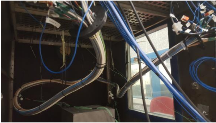
Figure 1: Photo qui met en évidence une disposition type de toron en chambre climatique
