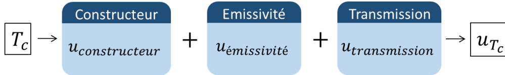
Figure 2 : Incertitude sur la température bichromatique T_c du pyromètre.
