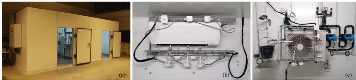
Figure 1 : Banc d'essai : (a) vue globale des deux chambres climatiques, (b) unité intérieure du climatiseur instrumenté, (c) unité extérieure du climatiseur instrumenté
