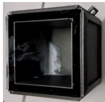
Figure 4 : Boîte test – MCP (en bulk) introduit dans l'entrefer (vue de dessus)
