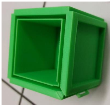
Figure 3 : Boîte test – films introduits dans 4 parois latérales (vue de dessus)
