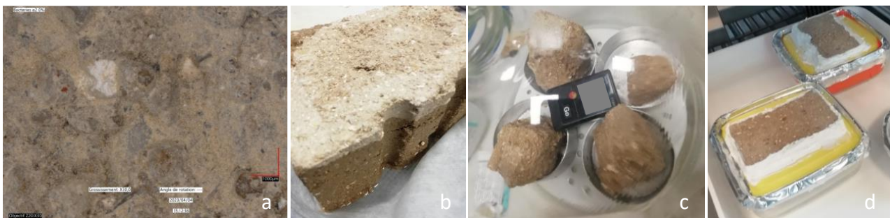
Figure 1 : Observation au microscope (a), essai d'absorption capillaire d'eau (b), de sorption (c) et de perméabilité à la vapeur d'eau (d)
