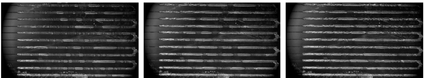
Figure 6. Ecoulements observés sur l'échantillon à 16 canaux pour G \approx 530 \text{ kg/m}^2\text{s} .
