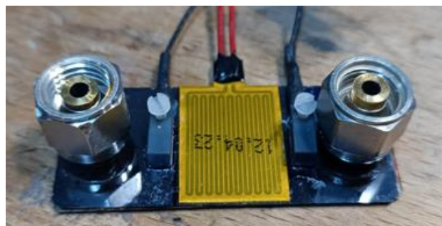
Figure 4 : Vue de la face arrière d'un échantillon équipé de prises de température et chaufferette, entre les connectiques d'alimentation fluïdique.
