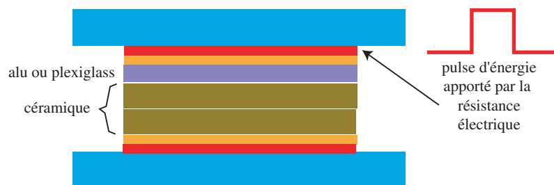
Figure 2 : Échantillon et sollicitation thermique.
