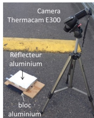
Figure 4 : Dispositif expérimental mis en œuvre en conditions extérieures
