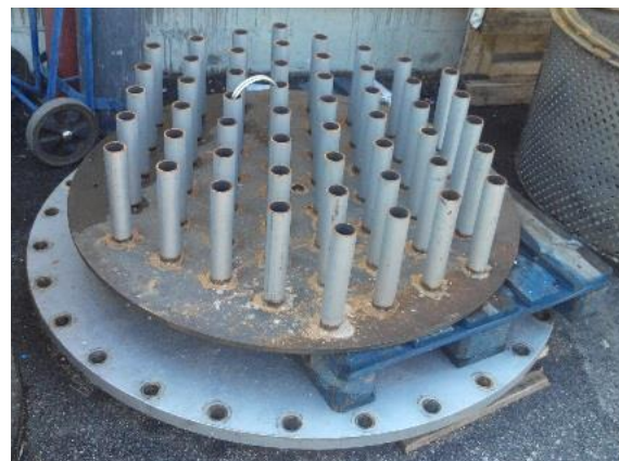
Figure 4 : Distributeur de la cuve thermocline de la centrale MicroSol-R [12]
