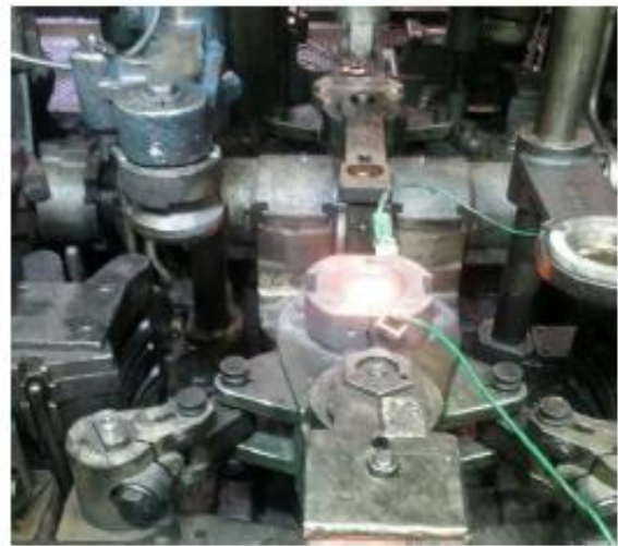
Figure 3 : Moule verrier instrumenté
