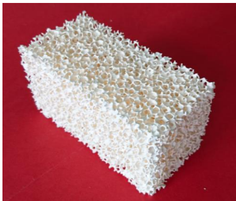
Figure 1 : Echantillon 10 PPI de la mousse d'alumine en dimension 10×5×5 cm
