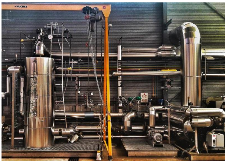
Figure 3 : Installation de stockage thermocline développée par Bertin Technologies. Vue du dispositif et schéma de la cuve de stockage
