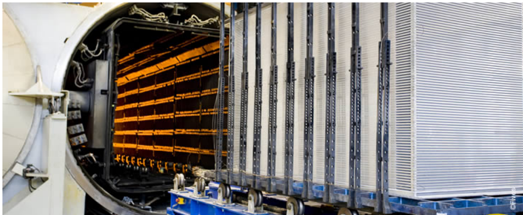
Figure 1 : Photo de l'un des deux fours sur site et d'un échangeur avant enfournement
