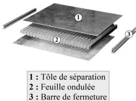
Figure 1 : Éléments constitutifs d'un échangeur
