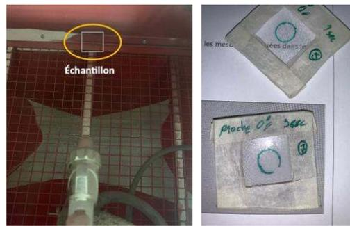
Figure 3. Sablage des échantillons de verre sodo-calcique
