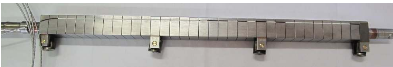
Figure 1 : Composant Type ITER équipé d'une FBG enfouie
