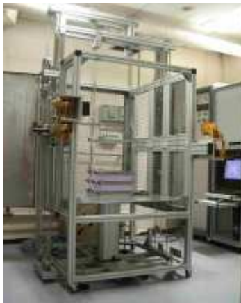
Conductimètre de référence métrologique de type PTGHT [+23 ; +800 °C] développé au LNE
