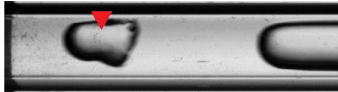
Écoulement à bouchons
