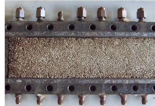
Différentes mousses testées dans la réaction endothermique de déshydrogénation.
