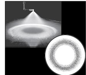
=> Rinçages cataphorèse : Flat jet (jet plat avec impact). Permettent de limiter les problème de mousse
