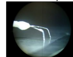
Sonde thermocouple fin 12.7 \mu\text{m}
