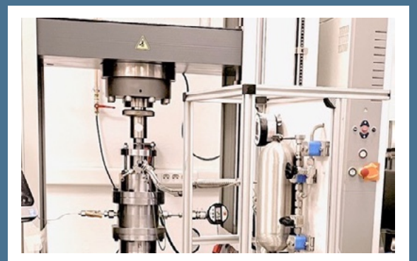
Expérimentation complexe de transfert de gaz couplée à un banc d'essai mécanique
