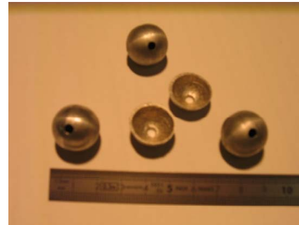
Fig. 7 : Effet de l'épaisseur de la paroi des billes creuses
