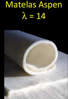
L'aérogel de silice, matériau développé dans les années 30 par Kistlest connu comme le seul solide superisolant thermique transparent conductivité thermique effective inférieure à 20 mW/m.K dans les CNTP
