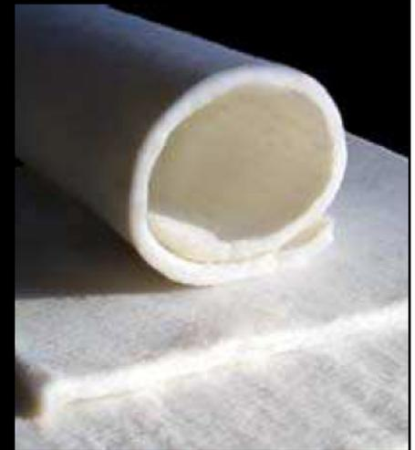
L'aérogel de silice, matériau développé dans les années 30 par Kistler, est connu comme le seul solide superisolant thermique transparent. Sa conductivité thermique effective est inférieure à 20 mW/m.K dans les CNTP.
