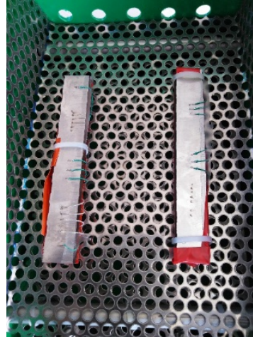
Fig. 2. Banc thermique 3\omega et échantillon SYSCORR
