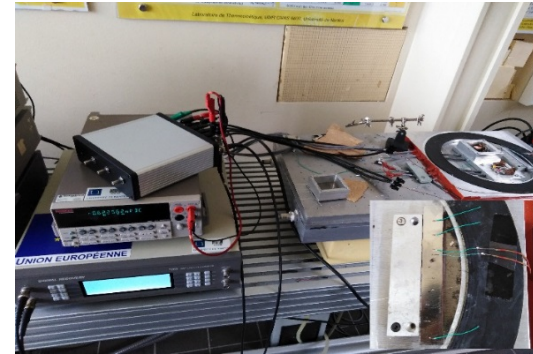
Fig. 2. Banc thermique 3\omega et échantillon SYSCORR
