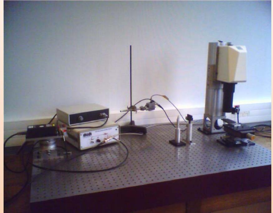
*+ Analyse des séquences IR par détection synchrone numérique (sous Labview™) avec prise de référence*
