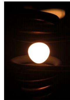
*Fig.1 Lévitation EM d'une goutte de nickel*
